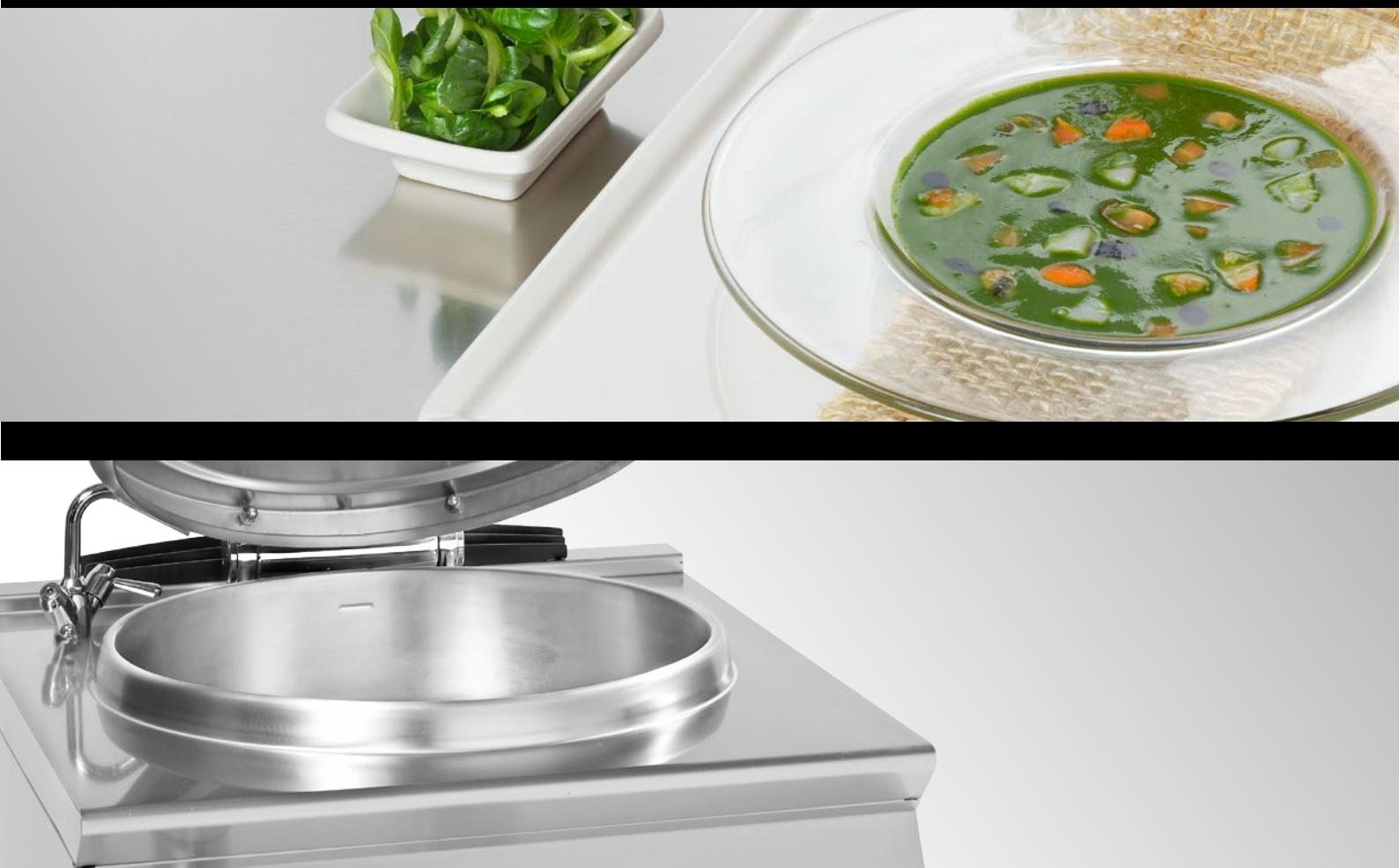
**ES** | Las ollas de la gama Unika se encuentran disponibles en las versiones con calentamiento directo o indirecto. En las versiones indirectas, el control de la presión de la membrana interna se efectúa mediante válvula de seguridad y manómetro analógico. El llenado de la cuba se realiza mediante una llave de paso articulada, mientras el vaciado se controla con una llave de paso en latón cromado con barra. El sistema autoclave (0,05 bar) se encuentra disponible por encargo.
